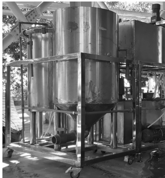
Hình 5. Cụm lắng đọng, lọc hấp phụ bằng than hoạt tính
