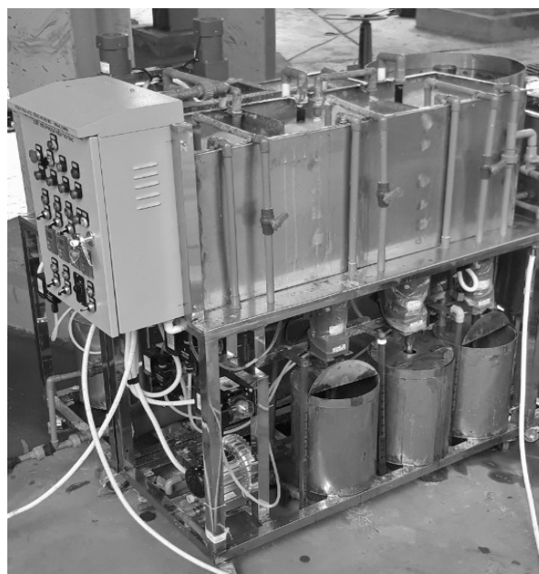
Hình 2. Cụm trung hòa 3 cấp
