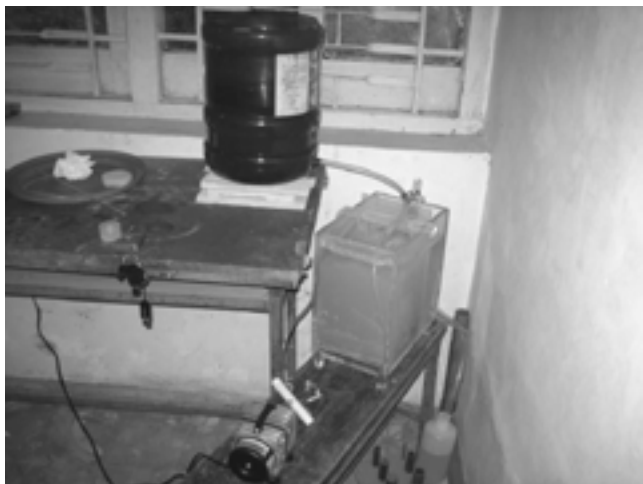
Hình 1. Mô hình thực nghiệm aeroten-lắng dòng chảy liên tục
