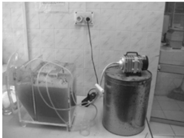
Hình 2. Thí nghiệm Aeroten theo mẻ
