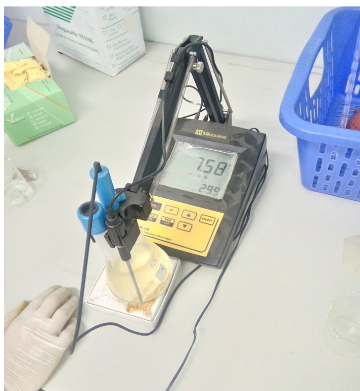
Hình 1.5 Ảnh chụp đo pH của mẫu nước phèn
