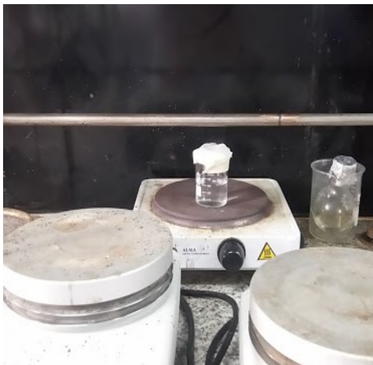
Hình 1.7 Ảnh chụp đun mẫu sau khi cho \text{NH}_2\text{OH}.\text{HCl}
