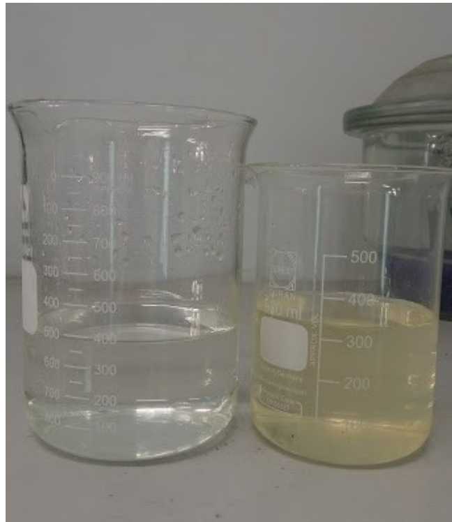
Hình 3.9 Ảnh chụp đối chiếu nước sạch với nước bị nhiễm phèn sắt
